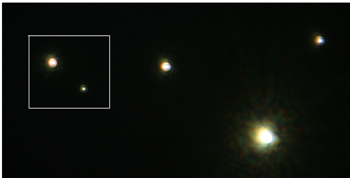
Fig. 22 – A pieno campo, fuoco ottimale, esposizione forte (le centriche più brillanti sono sovrapposte). Il riquadro indica il campo parziale utilizzato nelle foto seguenti (064a).
