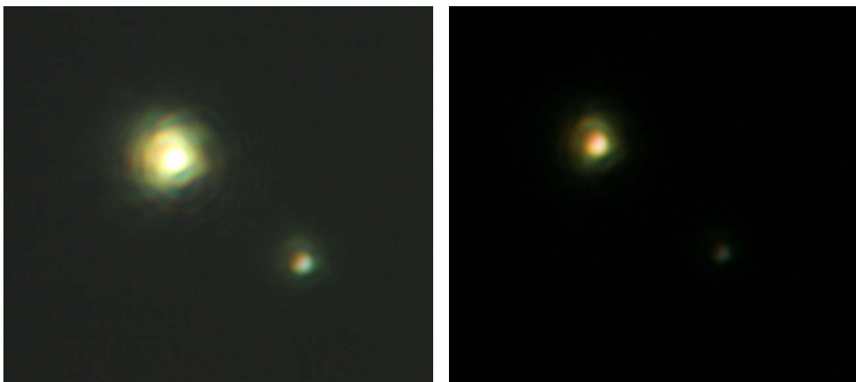
Figg. 27 e 28 – Campo ridotto. Fuoco “lungo”. Si nota una traccia di “immagine sfumata”. (70a e 68a)
