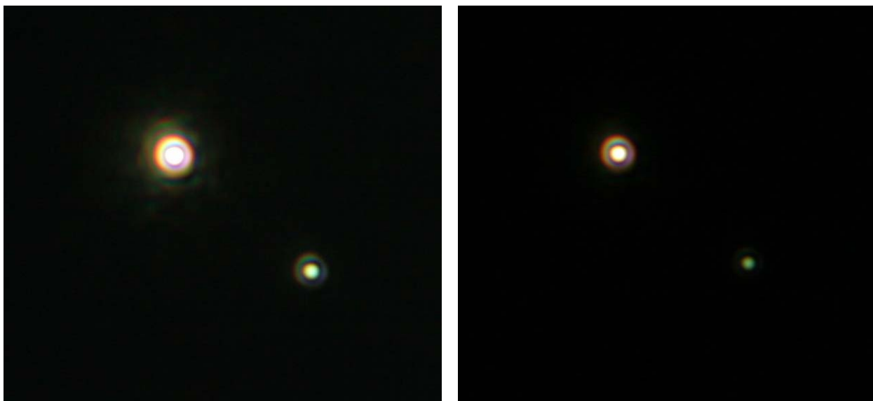
Figg. 25 e 26 – Campo ridotto. Fuoco ottimale, esposizione forte e debole. Le centriche sono quasi perfette, in quanto mostrano solo un anello evidente e la figura è simmetrica attorno al suo centro. (64b e 62a)
