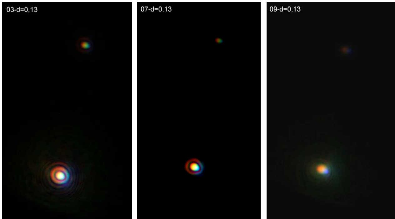
Fig. 129 – Esame con lo star test con lo stesso obiettivo e lo stesso oculare, ma con lamella di spessore insufficiente ( d = 0,13 mm). Oltre alla differenza fra la centrica sopra e sotto il miglior fuoco (ai lati), anche nel miglior fuoco la centrica appare di forma regolare ma di dimensioni maggiori rispetto a quella della figura precedente (sempre al centro). È in queste condizioni, di miglior fuoco, che la sferica può passare inosservata, benché produca sempre una perdita di risoluzione (e di microcontrasto).
