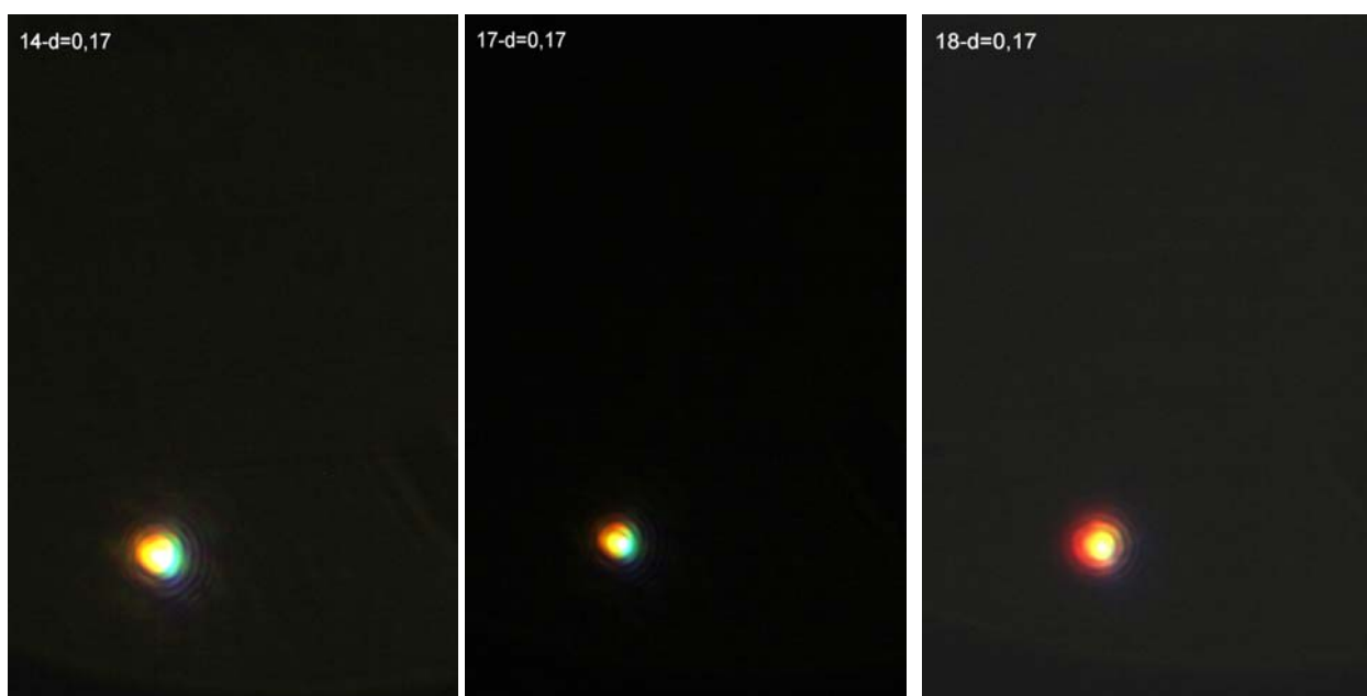
Fig. 128 – Esame dello star test al centro del campo. Oculare Zeiss Jena PK 32 \times . Ingrandimento elettronico successivo: maggiore di 5:1.
